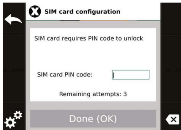
Après avoir saisi le code PIN, la configuration des paramètres de transmission via le réseau GSM de l'opérateur est disponible sous la touche **F4**. Le réglage des paramètres APN corrects, du login et du mot de passe d'un réseau GSM donné est nécessaire pour la transmission des données au système.
