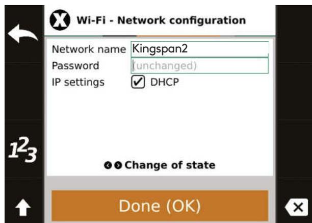
Les paramètres réseau avancés peuvent être configurés en décochant les options DHCP.
